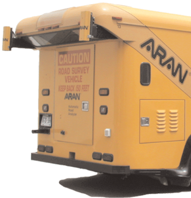
Illustré ici : Caméras de chaussée pointant vers le bas et système d'éclairage stroboscopique
