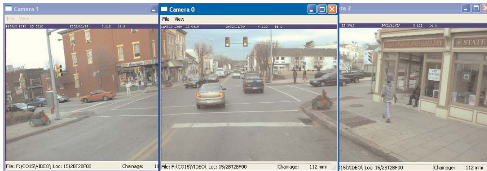
La imagen muestra: Una imagen de video panorámica (3 cámaras) de la ruta tomada a una resolución de megapíxeles (1380 x 1030), visualizada en el software VisiData de Roadware.
