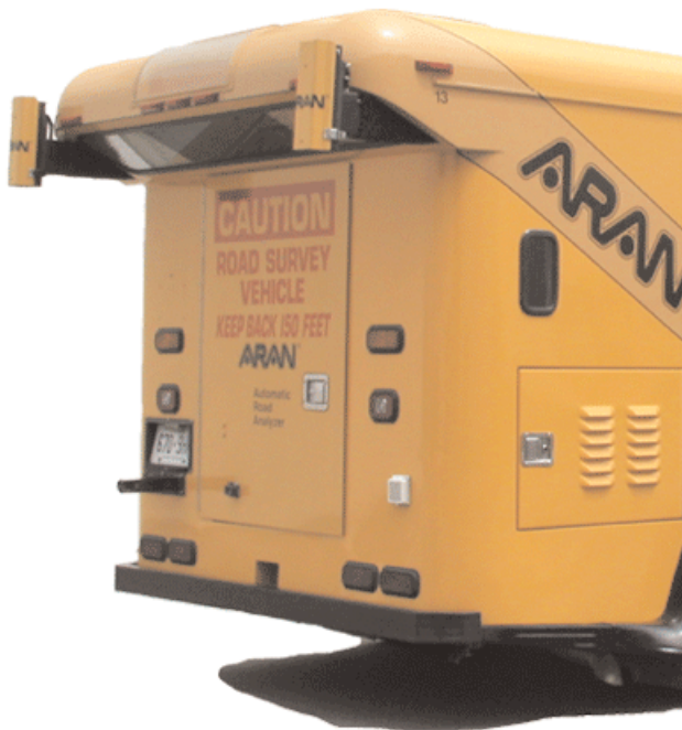
La imagen muestra: Cámaras de pavimento apuntadas hacia abajo y sistema de iluminación estroboscópica
